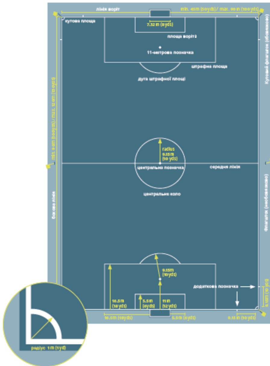
Мал. 17 Вимоги до розміру поля та розмітки (джерело: IFAB). Примітка: лінії належать до тих зон, які вони обмежують. Додаткові позначки у зоні флагштоків поза межами поля (9.15м з зовнішнього краю зони флагштоків) мають бути 24 см завдовжки, починаючи з 12см від лінії воріт/бокової лінії.
