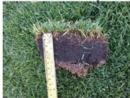
Пласт дернини з ґрунтовим профілем на поганім дренажем поклали поверх кореневої зони з вільним дренажем. Така система не витримає сильної зливи.
